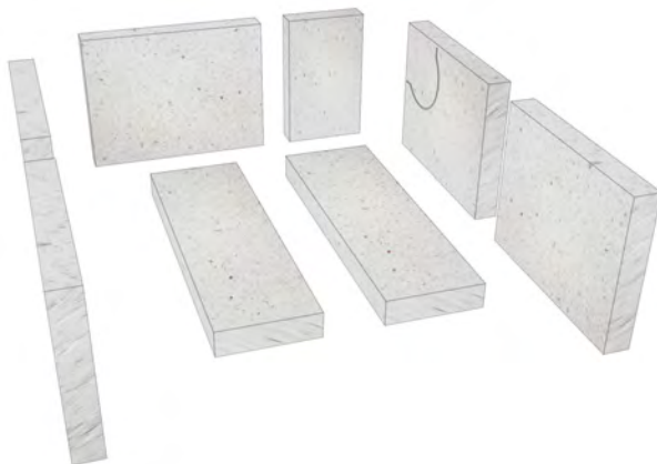
Abb. 2-3: Aufbau der Schamottsteine
